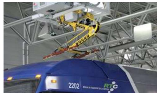
Figure 3 | Recharge par pantographe SOURCE: MTMD
