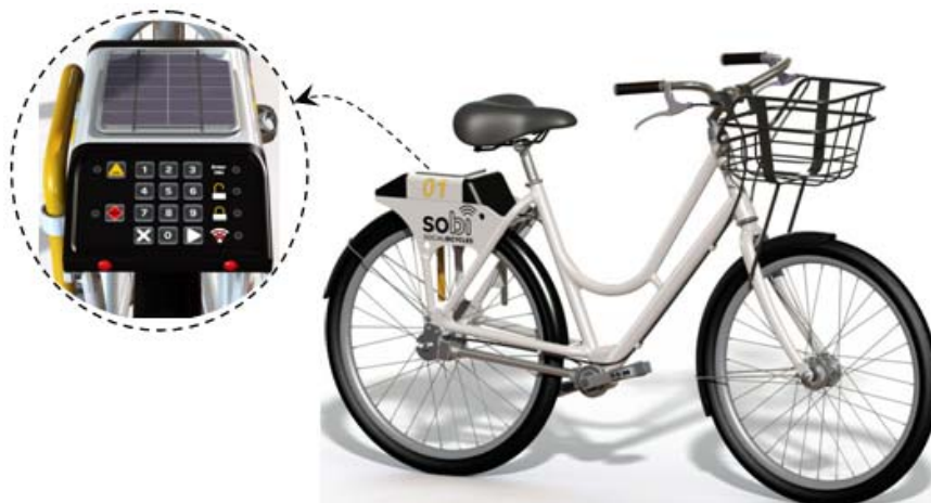
Figure 83: Le vélo libre service SoBi – Unité de contrôle alimenté par l'énergie solaire et la barre de sécurité en forme de U en jaune (Réf.: 86)
