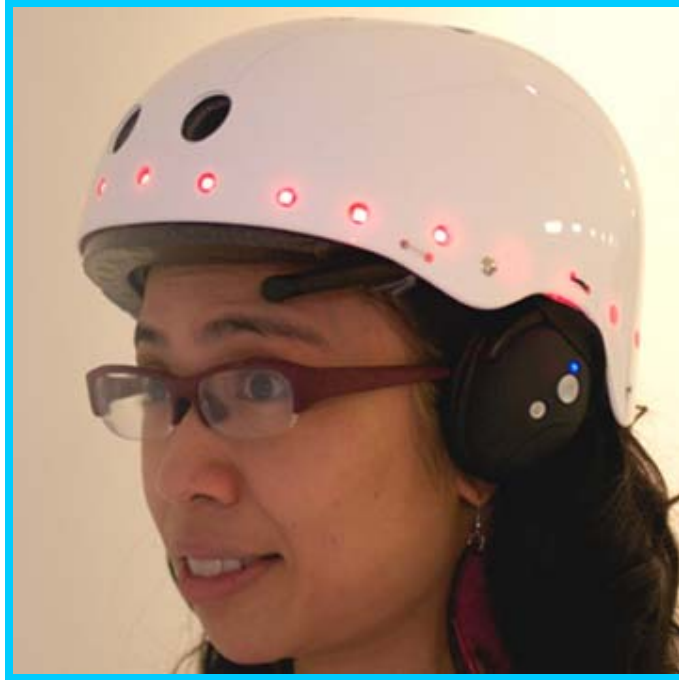
Figure 56 : Le casque MindRider montrant l'instrument EEG (sur l'oreille gauche) et les signaux lumineux associés au niveau de stress ressenti (Réf. : 64).
