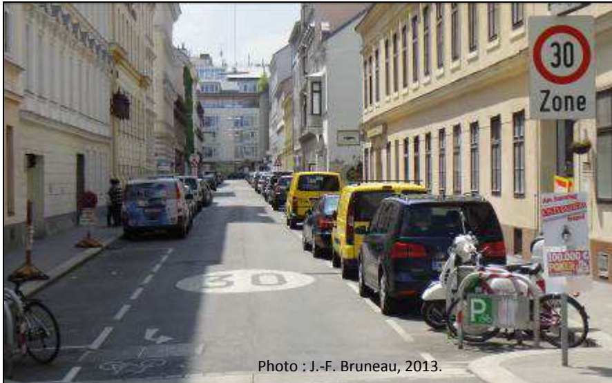
Figure 135 Double sens cyclable avec marquage léger à l'intersection seulement (Vienne, Autriche)
