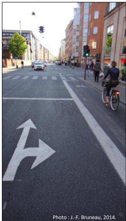
Figure 149 Ligne d'arrêt tronquée pour véhicules (Copenhague, Danemark)
