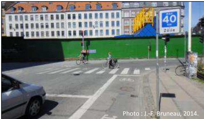
Figure 150 Ligne d'arrêt tronquée pour véhicules (Copenhague, Danemark)
