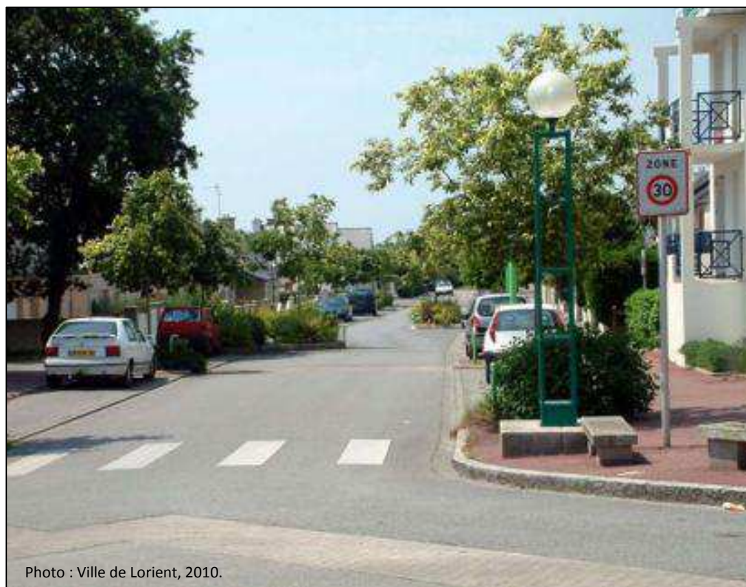
Figure 69 Chicanes par plantation et stationnement dans une rue large (Lorient, France)
