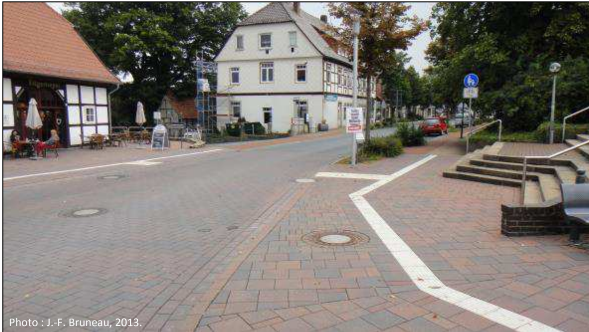
Figure 24 Séparations tactiles et passage piéton proposé en shared space (Bohmte, Allemagne)
