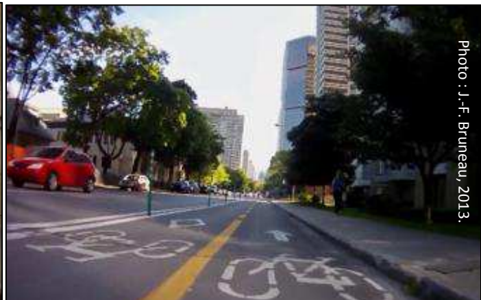
Figure 128 Bande cyclable bidirectionnelle avec bollards (Montréal, Québec)
