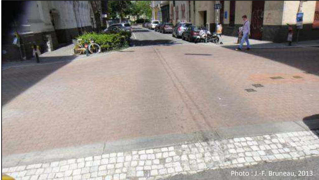
Figure 55 Intersection surélevée (Vienne, Autriche)
