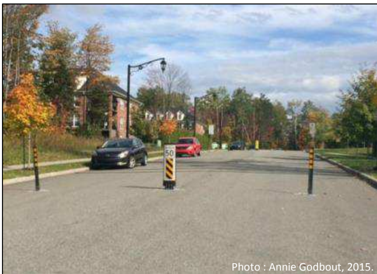
Figure 92 Balise centrale « maximum 50 km/h » avec balises de rétrécissement (Sherbrooke, Québec)
