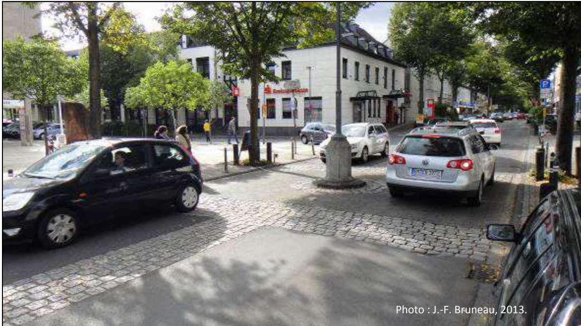
Figure 96 Refuge central linéaire jumelé à un passage piéton informel (Hennef, Allemagne)
