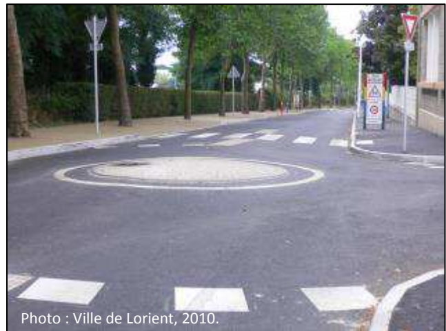
Figure 64 Le giratoire n’est pas franchissable (à gauche) et le mini-giratoire l’est (à droite)
