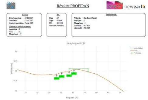
**Rappel de la méthode :** à partir d'une acquisition embarquée sur véhicule routier, des relevés sont réalisées avec un précision en cm
